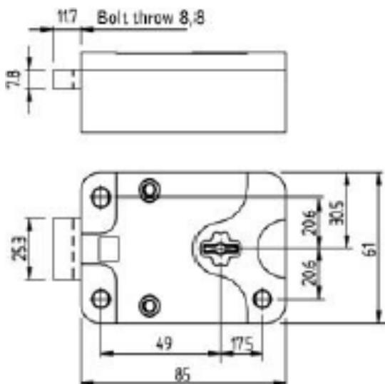
La serrure 6880.166 à 9 gorges certifiée A2P B/E, EN 1300 B, VdS 2 est livrée sans clés, pêne rentré, prête à être programmée sur n'importe quel jeu de clé ou sur clé « neutre » dite « clé de chantier »
